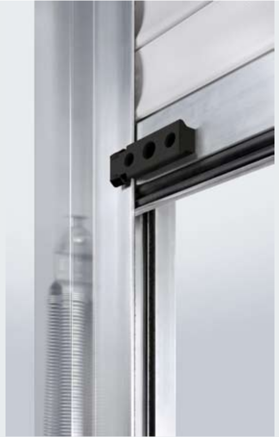
Técnica de muelle de tracción y carril-guía de aluminio con perfiles de deslizamiento de material sintético y juntas de cepillo situadas en el interior
