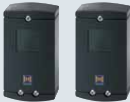
Célula fotoeléctrica unidireccional EL 51 Célula fotoeléctrica unidireccional con emisor y receptor separados. La célula fotoeléctrica es comprobada por el mando antes de cada movimiento de descenso. Conexión a través de cable de sistema (el largo se adapta a las medidas de la puerta). Alcance aprox. 8,0 m Dimensiones con ángulo de montaje: 60 x 165 x 43 mm (Ancho x Alto x Fondo) Índice de protección: IP 65
