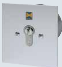
Contactor de llave ESU 30 con 2 llaves versión empotrada Función Impulso o Abrir / Cerrar a elegir. Dimensiones de la caja: 60 x 58 mm (d x Fondo) Dimensiones del embellecedor: 90 x 100 mm (Ancho x Alto) Escotadura en el muro: 65 x 60 mm (d x Fondo) Índice de protección: IP 54
