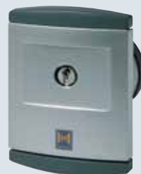
Contactor de llave STUP con 2 llaves versión empotrada Función Impulso o Abrir / Cerrar a elegir. Dimensiones de la caja: 60 x 58 mm (d x Fondo) Dimensiones del embellecedor: 80 x 110 mm (Ancho x Alto) Escotadura en el muro: 65 x 65 mm (d x Fondo) Índice de protección: IP 54
