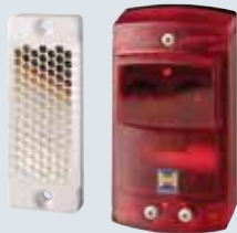
Célula fotoeléctrica RL 50 Célula fotoeléctrica de reflexión con módulo emisor / receptor y reflector. La célula fotoeléctrica es comprobada por el mando antes de cada movimiento de descenso. Conexión a través de cable de sistema (largo 2,0 m). Alcance aprox. 6,0 m Dimensiones: 68 x 97 x 33 mm (Ancho x Alto x Fondo) Reflector: 85 x 85 mm (Ancho x Alto) Índice de protección: IP 65
