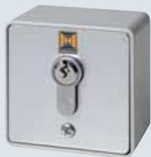
Contactor de llave ESA 30 con 2 llaves versión saliente Función Impulso o Abrir / Cerrar a elegir. Dimensiones: 73 x 73 x 50 mm (Ancho x Alto x Fondo) Índice de protección: IP 54
